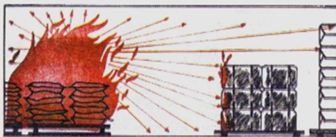
Fig. 1.7 - Transmissão de calor por irradiação
