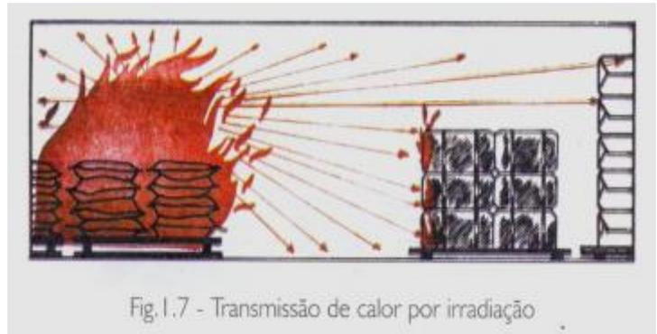
Fig. 1.7 - Transmissão de calor por irradiação
