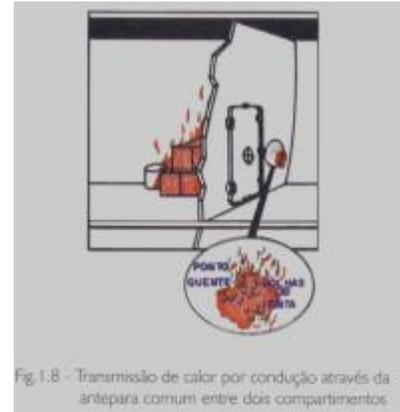
Fig. 1.8 - Transmissão de calor por condução através da anteparo comum entre dois compartimentos.
